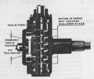
GEAR (Studs A+B) SHOWN AT MID-POSITION OF TRAVEL
